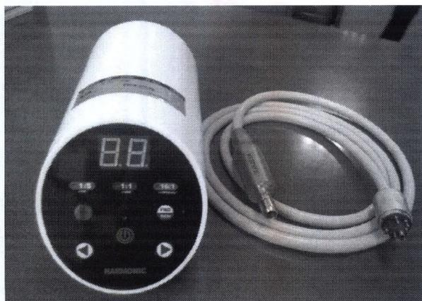
Шаг 2. Присоедините кабель адаптера и кабель микромотора к задней части рабочего блока микромотора.
